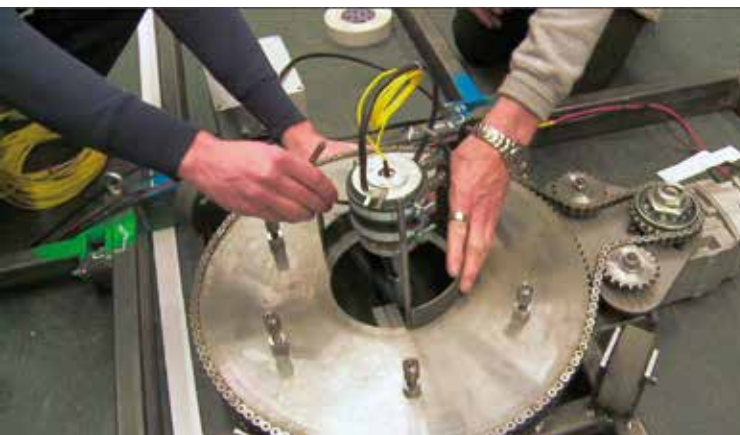
Een plaatwiel met draaikrans zorgde dat de 22m hoge paal ronddraaide. | FOTO: © NO&B
