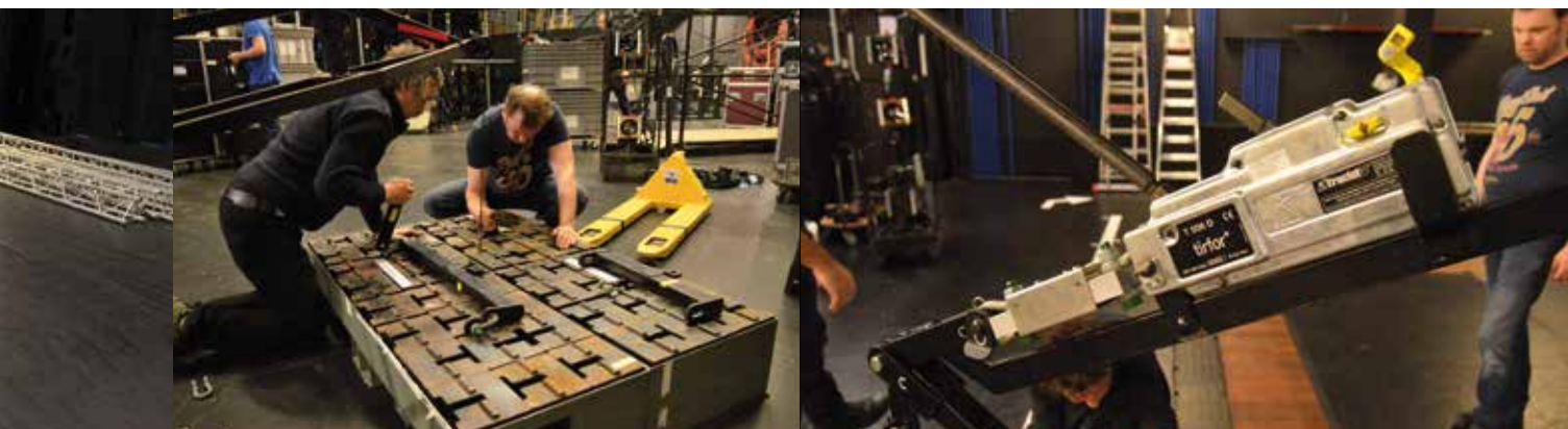
Links ligt de cable support nog plat op de vloer, midden het contragewicht met kluiten en rechts de tirfor met loadcell.
