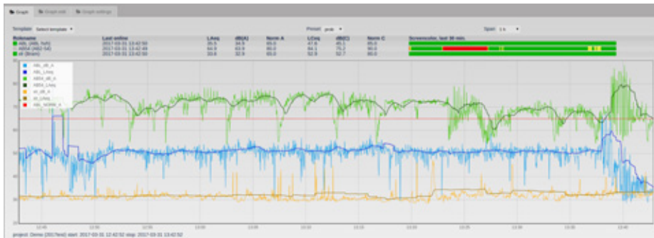
Samengestelde grafiek van resultaten van een dB-meting op meerdere punten over een bepaald tijdvak.
