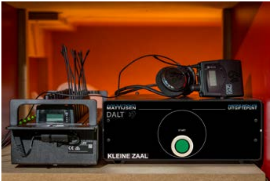
Als kers op de taart bestaat dan nog de mogelijkheid om het systeem uit te breiden met Digital Assistive Listening Technologie (DALT). Dit apparaat kan het signaal van de schotelmicrofoons analyseren en door middel van slimme algoritmes de geluiden die continu aanwezig zijn, zoals luchtbehandeling, dimmers of koeling van movingheads, eruit filteren.
