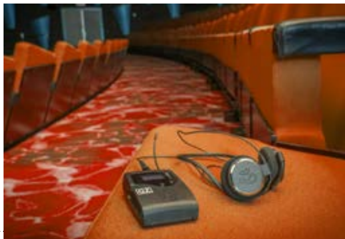
Bij dit systeem wordt de werking al bij uitgifte getest. De gebruiker krijgt eerst uitleg en hoort vervolgens een audiofragment. Hierdoor kan de gebruiker direct ervaren dat het systeem werkt.
